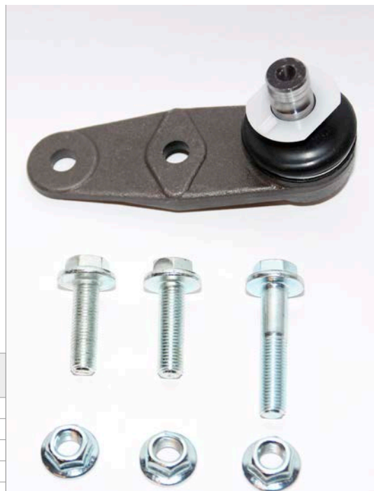
Новый комплект шарового шарнира от MOOG с пластиковой защитной пластиной пыльника.
